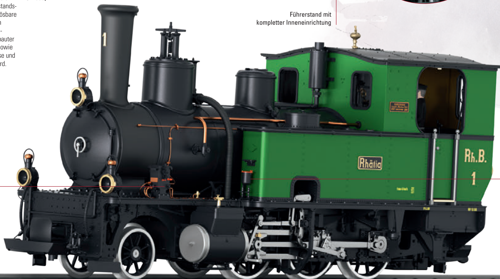
Feindetailliert zeigt sich die Schmierpumpe mit angesetzten Leitungen aus Kupfer und einem Stellhebel mit rot abgesetztem Griff
