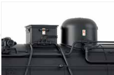
Detaillierte Nachbildung von Sandkasten und Dampfdom
