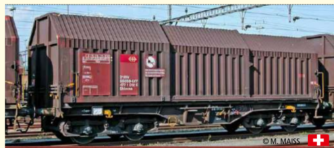
Teleskophaubenwagen Shimms SBB Betriebs-Nr. 31 81 466 9 011-6
