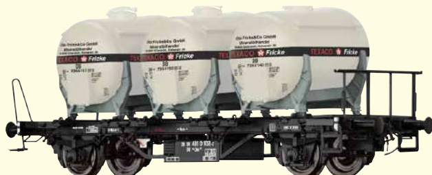
Behältertragwagen Lbs 577 "Texaco" DB Betriebs-Nr. 20 80 411 0 102-2
