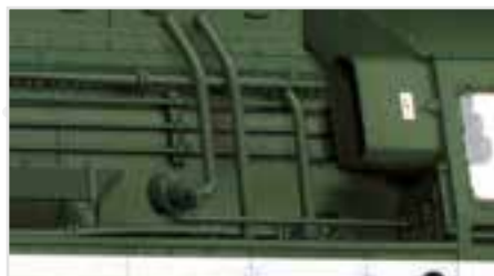
Korrekte Leitungsführung vor dem Führerhaus
