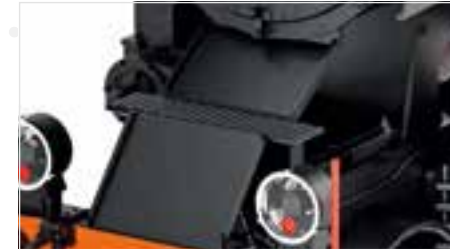
Schütte unter der Rauchkammertüre
