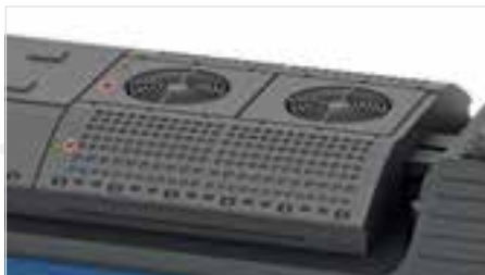
Korrekte Umsetzung der Klimaaggregate auf dem Dach
