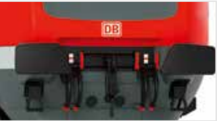
Aufwendig zugestützte Pufferbohle
