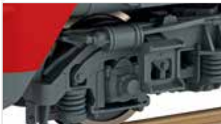
Bremszylinder detailliert ausgeführt
