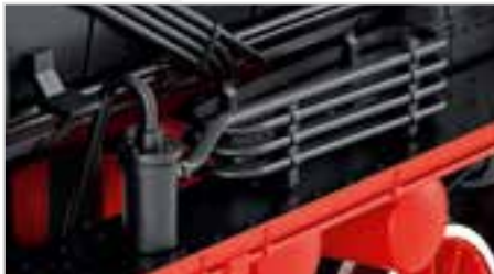
Aufwendig nachgebildeter Luftrockner mit Ölabscheider
