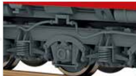
Vollständige Nachbildung der Bremsluftleitungen
