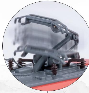
*Mit digital heb- und senkbaren Dachstromabnehmern
