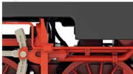
Freier Durchblick unter den Wasserkästen
