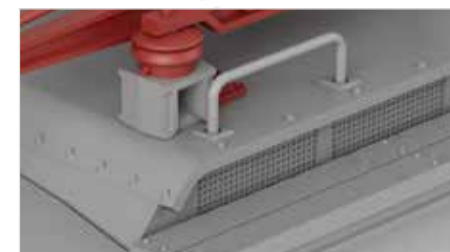
Freistehende Griffstangen im Dachbereich
