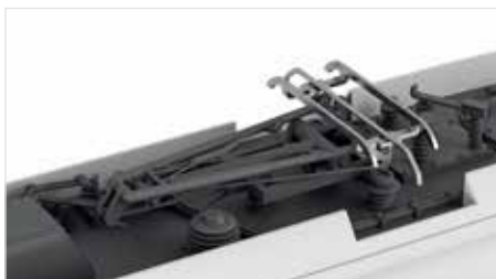
Stromabnehmeranordnung der Baureihe 408
