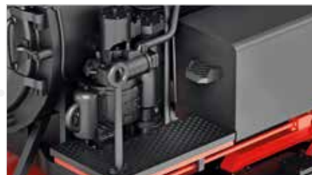
DB-Ersatzwasserkästen mit gerundeter Kante
