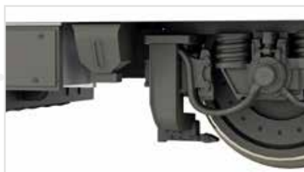
Verstärkte Ausführung der Sandfallrohre
