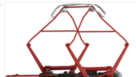
Zierlicher Stromabnehmer der Bauart SBS 54/10 mit unsichtbarer Befestigung
