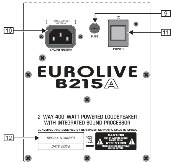
Abb. 2.2: Bedienelemente und Anschlüsse (B212A und B215A)
