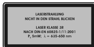
**Achtung:** Laser der Klasse 3R können auch ohne ein optisches Instrument vor dem Auge die Netzhaut nach kurzer Einwirkzeit schädigen. Deshalb: **Direkte Bestrahlung der Augen vermeiden!**
