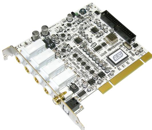
MAYA44 ist ein hochwertiges 24-bit 96kHz/192kHz Audiointerface mit 4 Eingangs- und 4 Ausgangskanälen, optimiert für Heimrecording- und DJ-Anwendungen.
