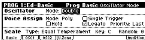
„Single“-Programs enthalten einen Oszillator. „Double“-Programs verwenden deren zwei. Mit einem „Oszillator“ ist hier ein kompletter Synthesizer gemeint, der per „Velocity Switching“ zwei Multisamples ansprechen kann, zwei Filter bietet sowie mehrere LFOs und Hüllkurven an den Start bringt.
