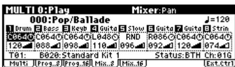
2. Wählen Sie mit dem ClickPoint den „Pan“-Parameter der Spur, deren Stereoposition Sie ändern möchten und drehen Sie am [VALUE]-Rad usw.
