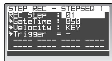
Wenn Sie mit dem 16KEYS [SELECT]-Taster „TRIGGER“ wählen, blinken die Taster 16KEYS [1]–[16], um anzuzeigen, welcher Schritt editiert werden kann. Drücken Sie einen [1]–[16]-Taster, um den Schritt zu wählen, den Sie eingeben möchten. Um Schritt 17 und folgende wählen zu können, müssen Sie mit dem 16KEYS PROGRAM BANK/TRIGGER [UP]-Taster dafür sorgen, dass die LENGTH-Diode jener Schrittgruppe leuchtet.
