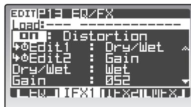
Ändern Sie die Einstellung der gewählten Parameter mit dem [EDIT1]- und [EDIT2]-Regler. Die verfügbaren Parameter richten sich nach dem Effekttyp.
