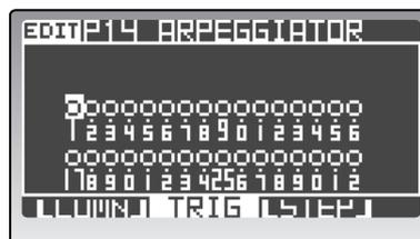
Der Status der Arpeggioschritte wird auf der Registerseite „P14-2: ARPEGGIATOR – TRIG“ angezeigt.
