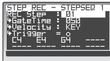
**Anm.** „REC Step“, „GateTime“ und „Velocity“ können auch während der Aufzeichnung geändert werden. Mit „REC Step“ können Sie bei Bedarf zu einem anderen Schritt springen (allerdings nur bis zum „Last Step“). Der entsprechende 16KEYS [1]–[16]-Taster zeigt dann die gewählte Position an. „GateTime“, „Velocity“ und „Note“ vertreten die Werte, die Sie zuvor aufgezeichnet haben.
