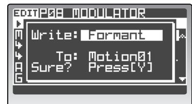
Sie können die Daten auch in einem anderen Speicher sichern als jenem, den Sie für die Aufnahme als „Puffer“ verwendet haben. Dann wird der ursprüngliche Inhalt des als Puffer verwendeten Speichers wiederhergestellt. Der Zielspeicher wird hingegen überschrieben.
