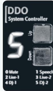
Der DDO™-Controller sorgt für einen atemberaubend druckvollen und natürlichen Sound, der von flüsterleise bis brachial laut stabil und bestens beherrschbar ist. Zur Anpassung an verschiedene Anforderungen und Konfigurationen bietet der DDO™-Controller des L.U.C.A.S MAX fünf unterschiedliche Presets.
