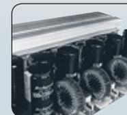
Digital-Endstufen: Mit einer extrem hohen Effizienz sind sie wesentlich leichter und kompakter als herkömmliche Verstärkermodule.
