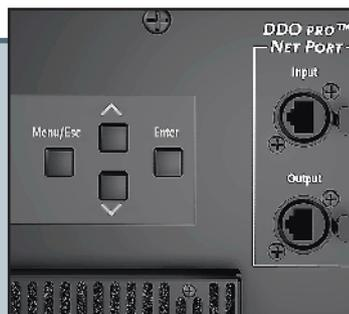
Der DDO-Pro™ Net-Port zur Vernetzung der CTA 118 Subwoofer mittels RJ 45 Ethercon-Steckverbinder.
