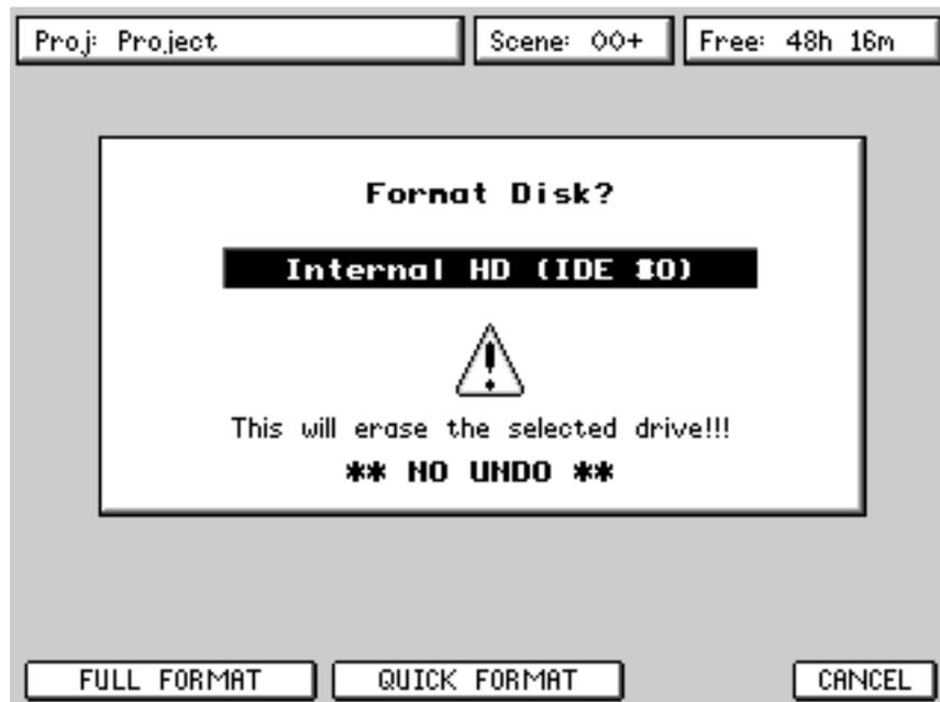
F1/F2 – FULL FORMAT formatiert die Disk und überprüft überdies die Disk-Oberfläche auf nicht beschreibbare Blöcke (Bad Blocks) und markiert diese gegebenenfalls. Alle auf dem Laufwerk befindlichen Daten werden gelöscht. Je nach Kapazität des Laufwerks kann dieser Vorgang eine ganze Weile in Anspruch nehmen.
