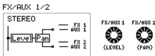
Der normalerweise zur Einstellung des Send Levels für FX/AUX 1 verwendete Regler ist nun für den Stereo Send Level zuständig, der Send Level Regler für FX/AUX 2 ist zum Pan-Regler des Stereo-Sends umfunktioniert.
