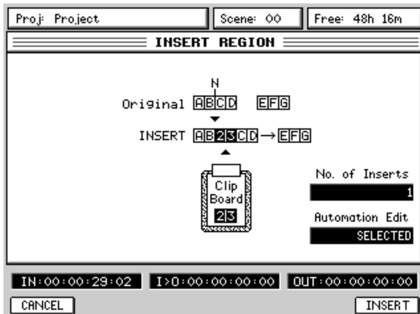
Die INSERT-Funktion fügt den Inhalt des Clipboards an der NOW-Position ein. Das nachfolgende Audiomaterial wird zeitlich entsprechend nach hinten verschoben.
