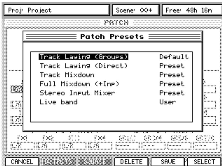
Wählen Sie mittels der CURSOR-Tasten das gewünschte Preset in der Liste an, und drücken Sie dann SELECT [F6], um das interne Patching des DPS24 vollständig umzukonfigurieren. Sie können Presets für jeden Zweck anlegen – für das Track Laying und Overdubbing wie auch für den Mixdown-Vorgang etc.
