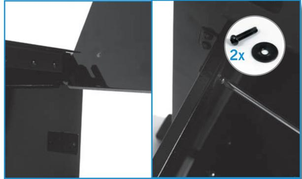
2 Schieben Sie die Rückwand vor den kleinen Winkelstücken ein und fixieren sie beidseitig mit den beigefügten Schrauben.
