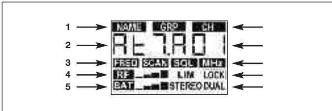
Fig. 5: Display del receptor de bolsillo SPR 4
