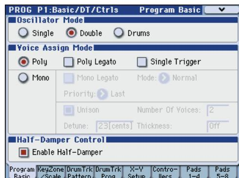
„**Single**“-Programs enthalten einen Oszillator. „**Double**“-Programs verwenden deren zwei. Beide Oszillatoren sind Multisamples, die man bei Bedarf per „Crossfade Velocity Switch“ wählen kann. Der Klang kann mit zwei Filtern, Hüllkurven und LFOs beeinflusst werden.
