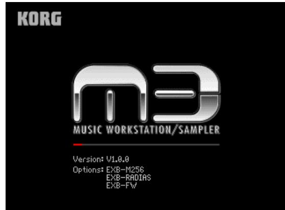
Nach der Installation von optionalen Platinen sollten Sie das Gerät einschalten und prüfen, ob die betreffenden Komponenten im Display erwähnt werden.
