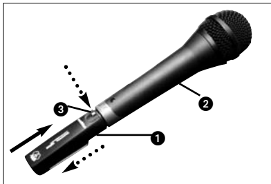
Fig. 4: Come collegare il trasmettitore al microfono e come sfilarlo dal microfono
