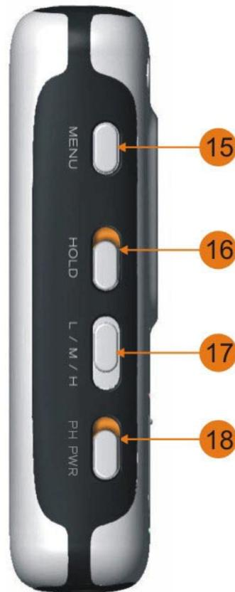
15. **Menü Taster:** Menüauswahl. Schaltet zwischen Haupt-Menü und Record Anzeige um oder dient als Zurück-Funktion aus einem Untermenü.
