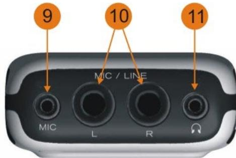
9. **Stereo Mikrofoneingang:** Der 1/8" Stereoeingang (Miniklinke) kann für Stereo- und Mono-Elektretmikrofone genutzt werden.
