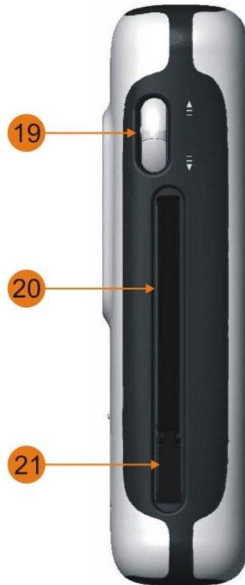
19. **Navigationsschalter:** Dieser Multifunktions-Taster übernimmt, abhängig vom aktuellen Wiedergabestatus von MicroTrack 24/96, unterschiedliche Funktionen. Der Schalter kann aufwärts und abwärts bewegt, sowie zur Bestätigung bestimmter Funktionen gedrückt werden.
