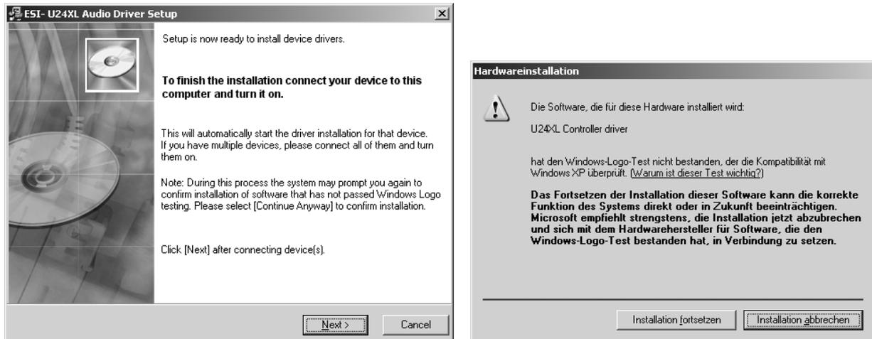
Nun können Sie den *ESI U24 XL Audio Driver Setup* Dialog mit *Next* bestätigen. Die Installation ist dann abgeschlossen. Um dies zu bestätigen, überprüfen Sie, ob das ESI-Symbol in der Taskleiste (wie auf dem folgenden Bild zu sehen) auftaucht.
