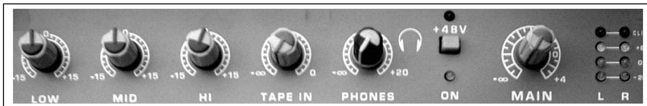
Mit dem Mainregler wird die Gesamtlautstärke an den Hauptausgängen eingestellt. An den ¼" Klinkenbuchsen wird ein verstärktes Boxen-Ausgangssignal ausgegeben (bitte schließen Sie hier nur Boxen an). Neben dem Main Regler befindet sich die LED Pegelanzeige zur Kontrolle der Signalspitzen.
