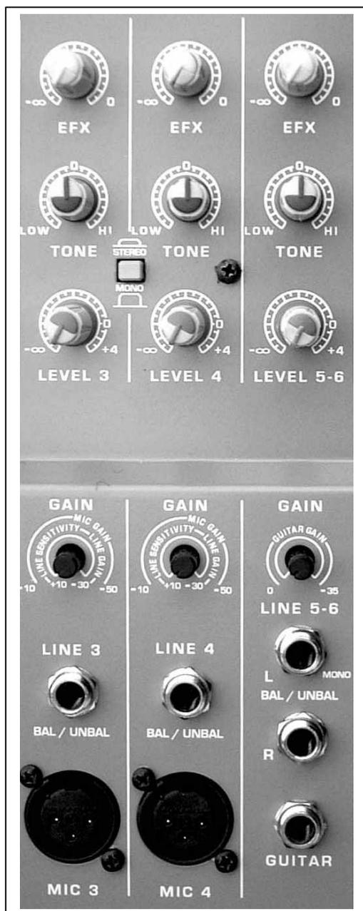
**Gainregler:** Der Gainregler wird zur Anpassung des Eingangssignals eingesetzt. Es gibt zwei unterschiedliche Empfindlichkeitsbereiche für die Anpassung von Mikrofon- oder Line-Signalen (XLR oder Klinkeneingang).
