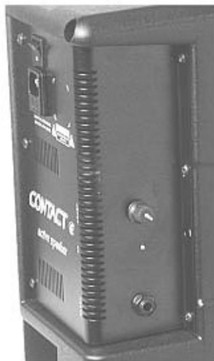
**Line Level Control:** Hiermit wird die Lautstärke des Line-Signals eingestellt (am Line-Eingang anliegend).
