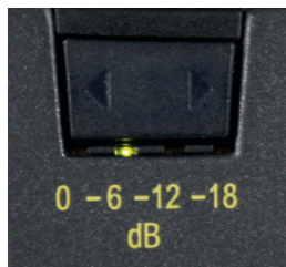
Abbildung 2: Wahlschalter für Vorabschwächung
