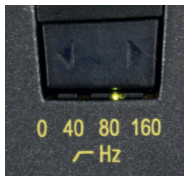
Abbildung 3: Wahlschalter für Tiefenabsenkung
