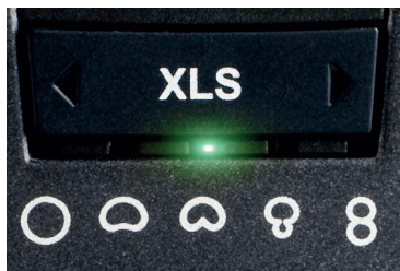
Figura 1: Conmutador-selector para las características direccionales
