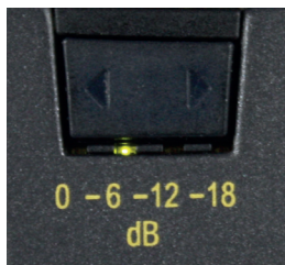
Figura 2: Conmutador-selector para preatenuación
