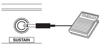
An der SUSTAIN-Buchse lässt sich ein Fußschalter oder ein Pedal anschließen. Das Pedal funktioniert genauso wie das Haltepedal (Forte- oder Dämpferpedal) eines akustischen Klaviers. Schließen
