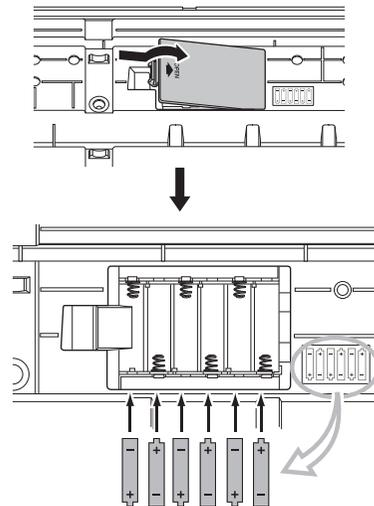
Für den Batteriebetrieb des Instruments benötigen Sie sechs 1,5-V-Batterien der Größe „AA“, Typ LR6 oder gleichwertige Batterien. (Es werden Alkali-Batterien empfohlen.) Wenn die Batterieleistung nicht mehr für den einwandfreien Betrieb ausreicht, müssen Sie sämtliche Batterien austauschen. Beachten Sie dabei bitte die nachstehend aufgelisteten Vorsichtsmaßnahmen. Falls nötig, speichern Sie auch alle wichtigen User-Daten (siehe Seiten 50, 88).
