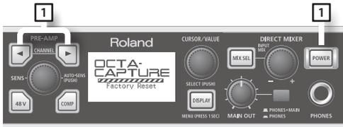
Im Display erscheint "Factory Reset", und der Vorgang wird ausgeführt.
