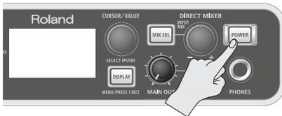
Das OCTA-CAPTURE ist mit einem Schutzschaltkreis ausgestattet, daher dauert es einen Moment, bis das Gerät betriebsbereit ist.
