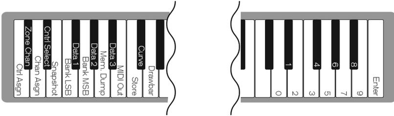
Axiom stellt über Sekundärfunktionen der Tasten erweiterte Programmierfunktionen bereit. Die verfügbaren Parameter sind am oberen Rand der Tastatur aufgeführt und durch Drücken des Edit-Tasters zugänglich. Auf dem LCD wird der numerische Wert des bearbeiteten Parameters angezeigt.
