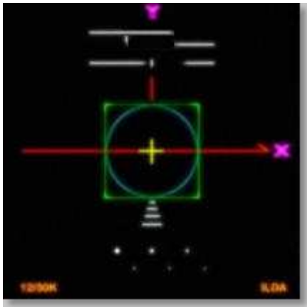
Zu hoch: Die horizontalen Linien sind nach rechts versetzt.
