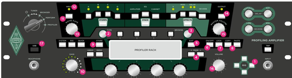
Im Folgenden finden sie eine Übersicht über sämtliche Regler und Taster auf der Benutzeroberfläche des Kemper Profiler und eine kurze Erklärung ihrer Funktion.
