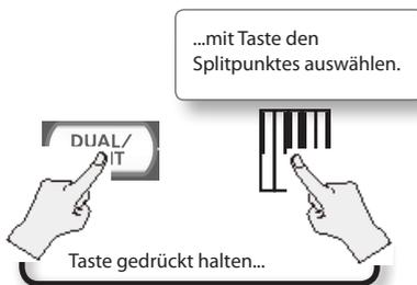
In der Voreinstellung befindet sich der Splitpunkt bei Drücken des [Split]-Tasters bei der Note F#3.
