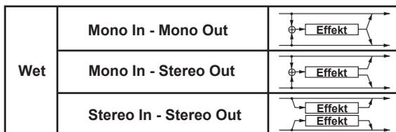
Oben links im Blockschaltbild sehen Sie, welche Ein- und Ausgangskonfigurationen die Effekte verwenden.
