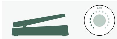
Premete completamente il pedale (posizione punta del piede). Ruotate il controllo **GAIN** e indicate il livello del vostro Suono Morph.
