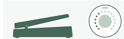
Nun bewegen sie das Pedal in die Zehenstellung. Anschließend drehen sie dann den **GAIN**-Regler auf den gewünschten Grad für den Morph-Sound.
