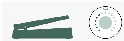
Mueve el pedal hasta la posición de puntera. Gira el mando **GAIN** y selecciona el nivel deseado para tu Sonido Morph.
