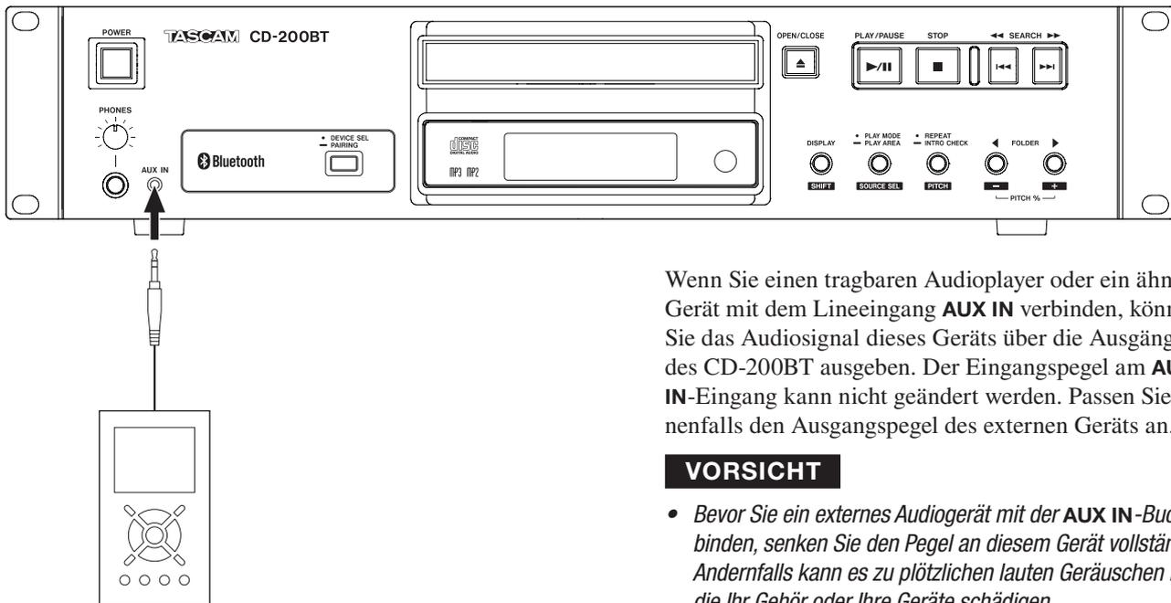
Wenn Sie einen tragbaren Audioplayer oder ein ähnliches Gerät mit dem Lineeingang **AUX IN** verbinden, können Sie das Audiosignal dieses Geräts über die Ausgänge des CD-200BT ausgeben. Der Eingangspiegel am **AUX IN**-Eingang kann nicht geändert werden. Passen Sie gegebenenfalls den Ausgangspiegel des externen Geräts an.
