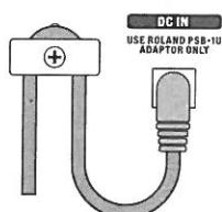
\* Um Betriebsfehler oder Schäden an den Lautsprechern zu vermeiden, sollten Sie das Gerät von anderen Geräten trennen und es ausschalten, wenn Sie den Netzadapter anschließen.
