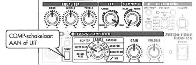
Deze instelling gebruikt de T-WAH-functie voor een funky geluid dat op het basspel reageert. Het WAH-effect wordt nog uitdrukkelijker met de versterkertypes SUPER FLAT of SESSION, die een respons tot in de hogere frequenties leveren. Gebruik de regelaar T-WAH om de gevoeligheid aan te passen. Wijzig het WAH-effect met de regelaar volgens de weergave van de aangesloten bas. U kunt een ander geluid verkrijgen voor elke verschillende speelstijl, zoals slap, gedempt of glissando.
