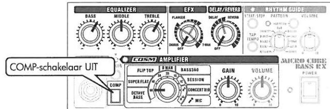
Dit is een dikker basgeluid verkregen door de ingangsgeluiden te mengen met geluiden die een octaaf lager liggen.
