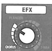
Effektklang ausgegeben wird) und der Klang vom linken Lautsprecher (der den direkten Klang ausgibt) genommen und dann im Raum selbst gemischt werden. Dadurch entsteht eine größere seitliche Streuung, als wenn die Klänge elektronisch gemischt werden, was einen natürlicheren Eindruck von Breite hervorruft.
