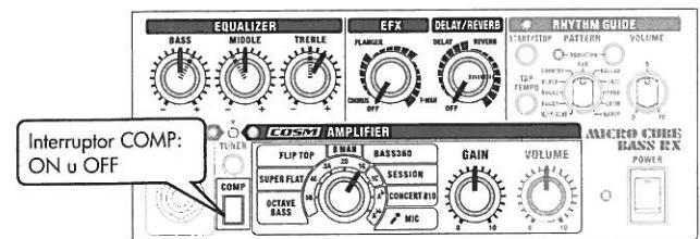
Este ajuste es ideal para obtener un magnífico sonido de bajo de bofetada (slap bass). Puede lograr un sonido prolongado activando el COMPRESSOR (COMP). Si aplica algo de reverberación, puede crear un sonido más suntuoso.
