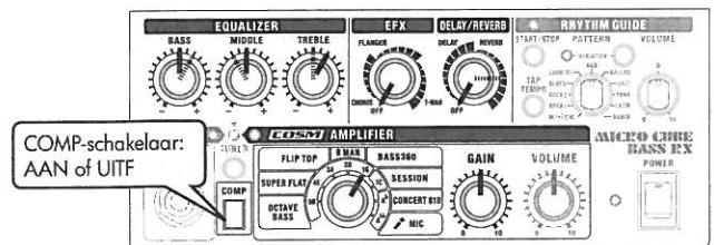
Deze instelling is geschikt voor een geweldig slap-basgeluid. U kunt een vlakker geluid verkrijgen door de COMPRESSOR (COMP) in te schakelen. Met wat weergalm creëert u een rijker geluid.
