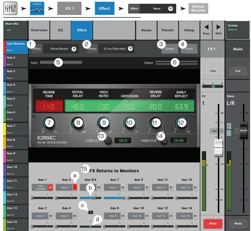
1. **Effect** – Durch Berühren dieser Schaltfläche wird die Art des Effekts ausgewählt.
