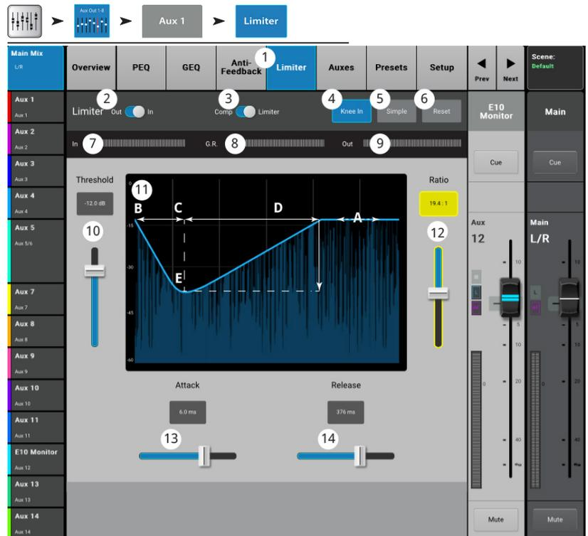
1. **Comp/Limiter (Registerkarte)** – Ruft den Comp/Limiter-Bildschirm auf. Beachten Sie, dass sich die Beschriftung dieser Registerkarte je nach der Einstellung des Comp/Limiter-Schalters ändert.
