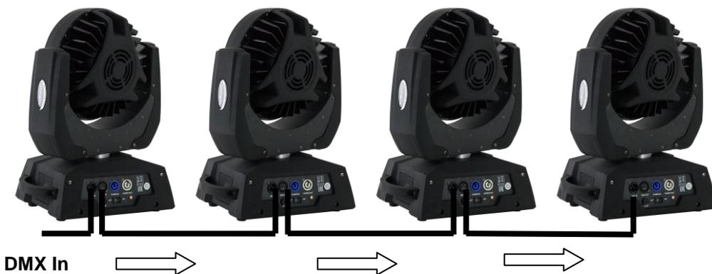
Für Anlagen mit sehr langen DMX-Kabelwegen oder hohen elektrischen Störeinflüssen, wie zum Beispiel in einer Diskothek, ist es empfehlenswert, einen DMX-Terminator zu verwenden. Der DMX-Abschlusswiderstand wird in einem XLR-Stecker als 120  $\Omega$  Widerstand zwischen Pin 2 und 3 ausgeführt der in die letzte Ausgangsbuchse der DMX-Linie gesteckt wird.
