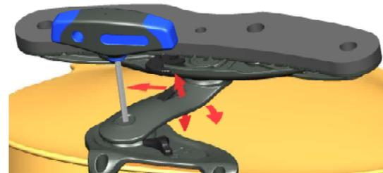
Öffnen Sie mit dem Inbusschlüssel die Schraube nur soweit, dass Sie den Schulterstützen-Arm drehen und in der Höhe bewegen können. Wählen Sie nun die neue Position des Polsters und halten mit einer Hand den Schulterstützen-Arm, während Sie die Schraube **nicht zu fest** anziehen.
