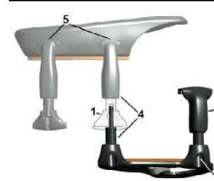
Demontieren Sie den Spannhaken (1) vom Befestigungselement des Kinnhalters, indem Sie die Kreuzschlitzschraube ganz herausdrehen und die beiden Teile auseinander ziehen.
