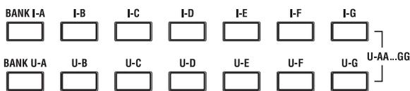
Mit den Tastern BANK I-A...G, U-A...G wählen Sie im Program-Modus die Program-Bank und im Combination-Modus die Combination-Bank. Außerdem erlauben die Taster im Combination- und Sequencer-Modus die Anwahl eines Programs für die Timbres/Spuren.
