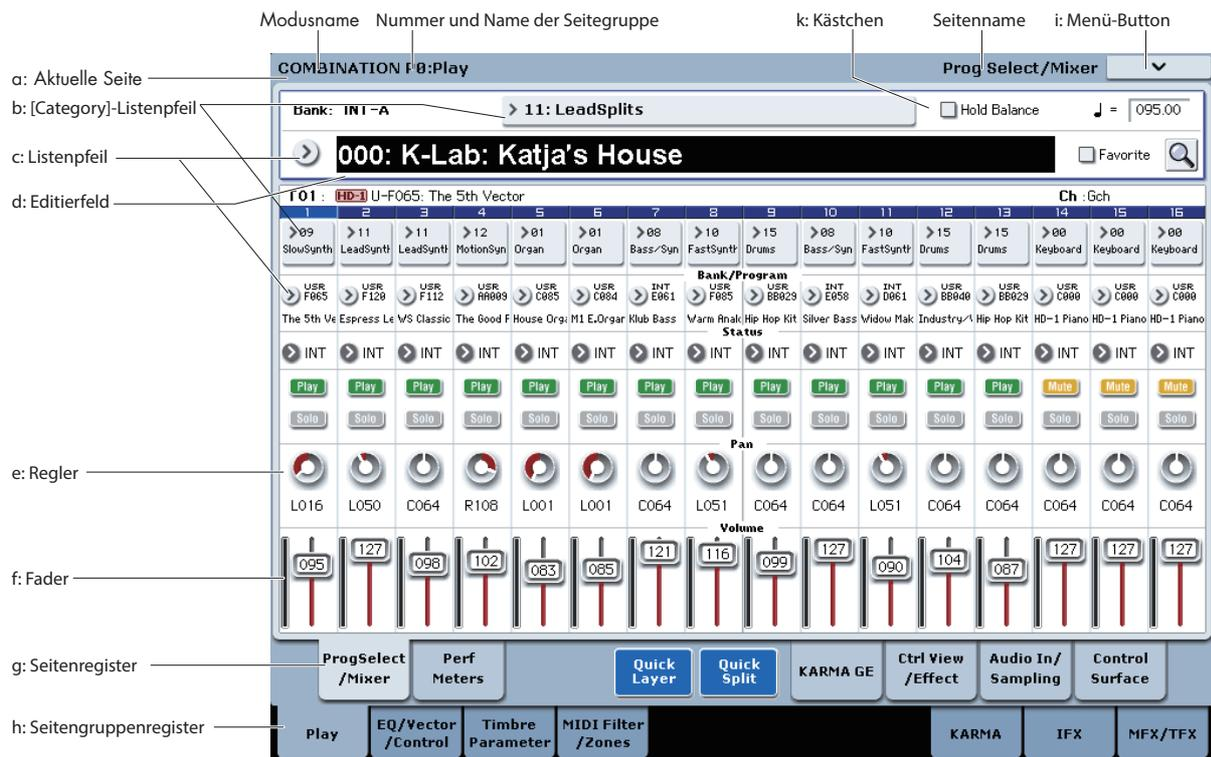
Der KRONOS enthält das grafikfähige und druckempfindliche „TouchView“-Display von Korg. Wenn Sie Objekte antippen, die im Display angezeigt werden, können Sie Display-Seiten selektieren, Parameterwerte einstellen, Text eingeben, virtuelle Patch-Verbindungen herstellen usw.
