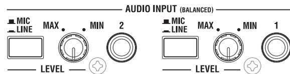
Die Eingänge 1 und 2 sind als symmetrische 1/4"-TRS-Buchsen ausgeführt. Hier können Mikrofon- und Line-Signale angelegt werden. Beide Eingänge weisen dieselbe Bestückung auf.
