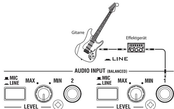
⚠ Eine Gitarre mit passiver Elektronik (ohne internen Vorverstärker) gibt ein Signal mit einer ungeeigneten Impedanz aus und kann nicht direkt gesampelt werden. Solche Gitarren müssen über den Umweg eines Effektpedals oder Vorverstärkers angeschlossen werden.
