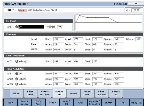
Mit der Filterhüllkurve kann man nicht nur das Filter, sondern auch andere Parameter beeinflussen. Der EG wird auf der „Filter EG“-Registerseite programmiert. Welchen Einfluss er genau auf das Filter haben soll, müssen Sie auf der „Filter Mod“-Registerseite einstellen.
