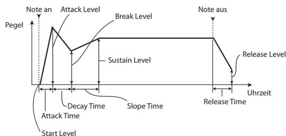
Der HD-1 bietet drei EGs: Pitch (Tonhöhe), Filter und Amp (Lautstärke). Diese erzeugen relative Wertänderungen der relevanten Klangaspekte. Außerdem lassen sich die Hüllkurven zum Beeinflussen anderer Program-Parameter per „AMS“ nutzen.
