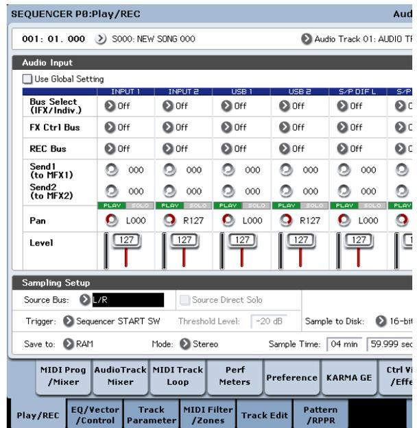
Stellen Sie „REC Source“ („P0: Play/REC- Audio Track Mixer“-Seite) so ein, dass das über Audio-Eingang 1 („In 1“) eingehende Signal auf Audiospur 1 geroutet wird.
