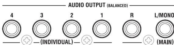
Verbinden Sie diese Ausgänge mit den Eingängen eines Verstärkers oder Mischpults. Zusätzlich zu den Stereo-Summenausgängen L/MONO und R bietet der KRONOS vier Einzelausgänge.
