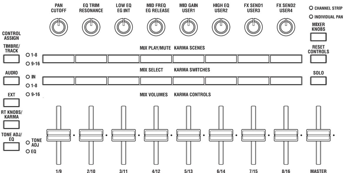
Die Dioden links neben diesem Taster zeigen an, ob momentan die Timbres/Spuren 1 – 8 oder 9 – 16 angesteuert werden. Mit dem **TIMBRE/TRACK**-Taster wechseln Sie von der einen Gruppe zur anderen.
