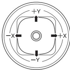
Der Joystick kann in vier Richtungen ausgelenkt werden: nach links/rechts, zu Ihnen hin (vorwärts) und von Ihnen weg (rückwärts). Jeder Richtung kann eine andere Funktion (z.B. Program- oder Effektparameter) zugeordnet werden. Die Zuordnungen lassen sich für jedes Program separat definieren. Oftmals wird aber folgendes System verwendet:
