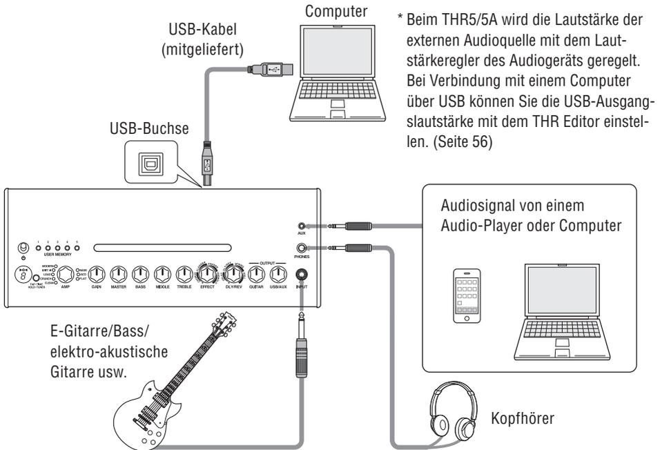
\* Beim THR5/5A wird die Lautstärke der externen Audioquelle mit dem Lautstärkereger des Audiogeräts geregelt. Bei Verbindung mit einem Computer über USB können Sie die USB-Ausgangslautstärke mit dem THR Editor einstellen. (Seite 56)
