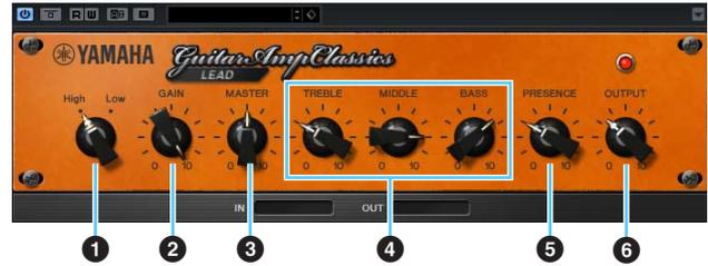
Der Verstärkertyp LEAD simuliert einen hoch verstärkenden Röhrenverstärker, der viele Obertöne erzeugt. Er ist ideal für Lead-Gitarre geeignet, die sich gegen die Band durchsetzt, kann aber auch für einen glitzernden Begleit-Sound eingestellt werden.
