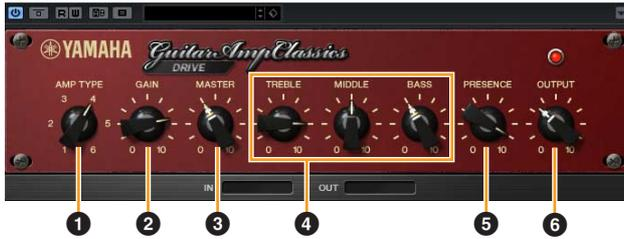
Der Verstärkertyp DRIVE bietet eine Auswahl an Distortion-Klängen, die den Klang verschiedener hoch verstärkender Röhrenverstärker simulieren. Von leicht übersteuertem Overdrive bis zu starken Distortion-Effekten für Hardrock, Heavy Metal oder Hardcore-Stile bietet dieses Modell eine große Klangvielfalt.
