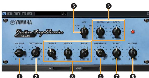
Dieser Verstärkertyp ist auf einen Clean-Sound optimiert, indem die scharfe Brillanz von Transistorverstärkern simuliert wird. Der Klangcharakter dieses Verstärkermodells bietet eine ideale Plattform für die Aufnahme mit Multi-Effekten. Außerdem besitzt er integrierte Chorus- und Vibrato-Effekte.
