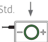
3. Grünes Dauerlicht= Gerät ist vollständig aufgeladen
