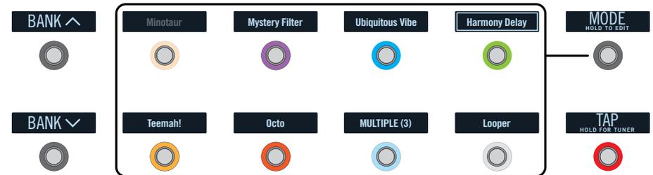
**Anmerkung:** Wenn einem Fußtaster mehrere Blöcke zugeordnet sind, lautet seine Beschriftung “MULTIPLE (X)” (das “X” vertritt die Anzahl der Zuordnungen). Diese Blöcke können gemeinsam ein- und ausgeschaltet werden. Wenn bestimmte Blöcke aktiv und andere ausgeschaltet (Bypass) sind, ändert der Fußtaster den Bypass-Status der einzelnen Blöcke.
