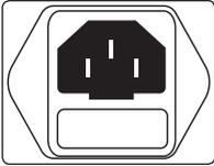
**IEC-Netzbuchse:** Ihr R65/R80 bietet eine Buchse zum Anschluss eines herkömmlichen IEC-Netzkabels.
