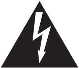
Zeigt an, dass ein Potentialunterschied auftreten kann, der Tod oder schwerwiegende Verletzungen hervorruft, wenn das Gerät nicht korrekt gehandhabt wird.
