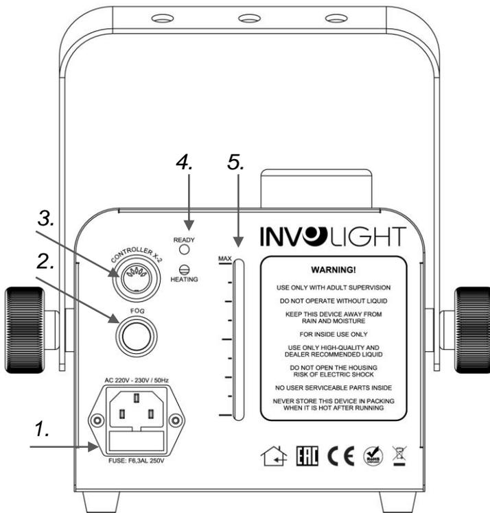
**1. POWER IN:** IEC Stromeingangsbuchse mit Sicherungshalter für F6,3AL250V Sicherung.
