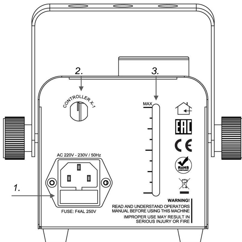
**1. POWER IN:** Entrada con conector IEC con fusible F6,3AL250V de protección.
