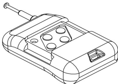
Si desea utilizar el control inalámbrico para su FOG900, por favor, tire de la antena por completo para garantizar una conexión segura. El control remoto tiene un alcance máximo de 30 – 50 m al aire libre. Así que usted puede utilizar el mando de manera ideal también para el teatro o fines de presentación.
