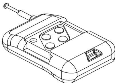
Pour utiliser le contrôleur sans fil pour FOG900, sortez complètement l'antenne pour assurer une connexion sécurisée. La télécommande a une portée maximale de 30 - 50 m en plein air. Ainsi, vous pouvez utiliser la télécommande au théâtre et à des fins de présentation.
