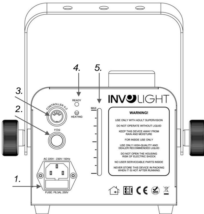
**1. POWER IN:** Connecteur d'entrée IEC avec protection fusible F6,3AL250V.
