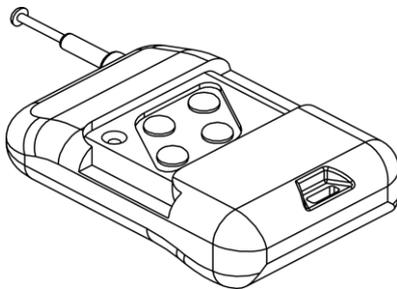
Wenn Sie die Funkfernbedienung für Ihre „FOG900“ nutzen möchten, ziehen Sie die Antenne bitte ganz aus, um eine sichere Verbindung zu gewährleisten.
