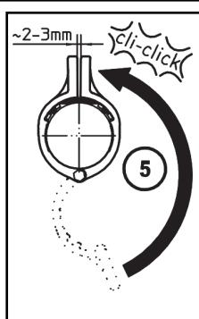
5 Klappen Sie jetzt die andere Hälfte der Spannschelle um das Bein bis es hörbar einrastet, so dass beide Laschen nur ein Schlitz von wenigen Millimetern trennt.
