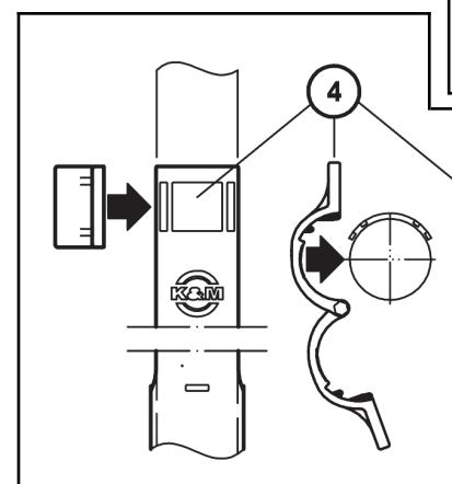
4 Am oberen Ende des Schafes befinden sich drei Aussparungen. An dieser Stelle legen Sie die Spannschelle seitlich an das Fußrohr.
