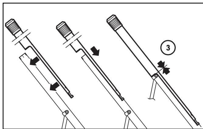
3 Nun schieben Sie das Rohr (der lange Schaft zeigt dabei nach außen) bis zum Anschlag auf das Fußrohr auf.
