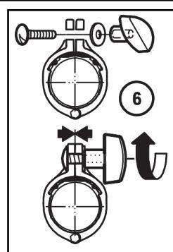
6 Führen Sie die Schloßschraube durch die Vierkantbohrung an einer der beiden Laschen. Dann die Scheibe aufbringen und die Flügelmutter fest anziehen.
