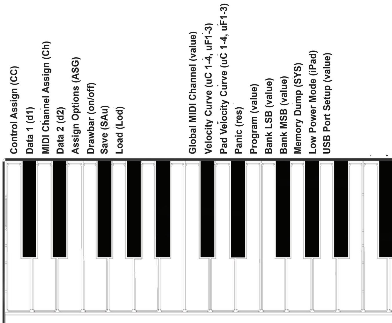
Beim Impact LX49+ und LX61+ stehen identische Menütasten zur Verfügung, allerdings ist die Werteeingabe beim LX61+ um eine Oktave nach oben verschoben. Auf dem Gerät sind die Parameternamen jeweils aufgedruckt.
