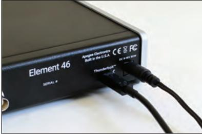
1. Schließen Sie das Netzteil an Element an.
