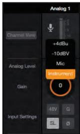
„Instrument“ bei Anschluss eines 6,35 mm Klinkenkabels.
