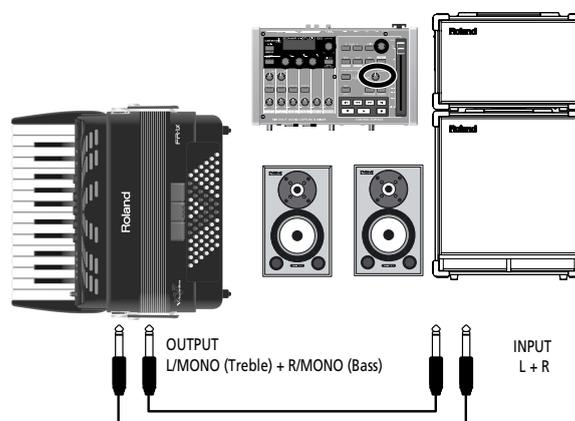
Verwenden Sie entweder ein langes Signalkabel (10m oder mehr) oder ein optionales Funksystem (empfohlen).
