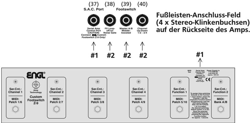
**#1 ENGL Custom Footswitch Z-9:** Diese Spezialfußleiste wird über ein Stereo-Klinkenkabel an der Buchse Serial Amp Control Port (37) mit dem Amp verbunden. Hiermit lassen sich vier Kanäle *Clean*, *Crunch*, *Lead (3)*, *Lead (4)* direkt über die vier Channel Taster abrufen und zusätzlich zwei Sonderfunktionen (z.B. *Middle-boosted* und *FX Loop*) steuern.
