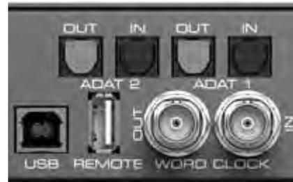
**ADAT2 I/O.** TOSLINK. Standard ADAT optical Port, 8 Kanäle. Kann nach Umschaltung im Settingsdialog auch als optischer SPDIF Ein- und Ausgang genutzt werden.
