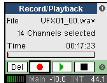
**Transport Bar.** Durch Drehen des Encoders 2 bewegt sich der Cursor über *Del* (Delete), *Stop*, *Play/Pause* und *Record*. Die selektierte Funktion wird durch einen Druck auf Encoder 2 aktiviert.
