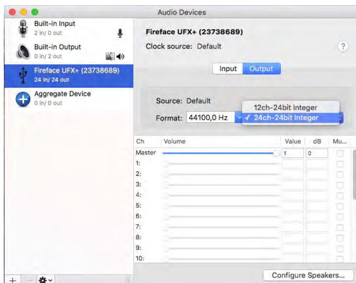
Mac OS X unterstützt USB Audio 2.0, sogar mit mehr als 2 Kanälen. Das UFX II bietet 24 Eingangs- und 24 Ausgangskanäle bei bis zu 96 kHz. Es wird als "Fireface UFX II (xxxxxxx)" im Audio MIDI Setup gezeigt, sowohl im normalen als auch im CC-Modus. Im CC-Modus verschwindet der USB Settingsdialog, und TotalMix zeigt – wenn überhaupt – ein 'disconnected' UFX II.
