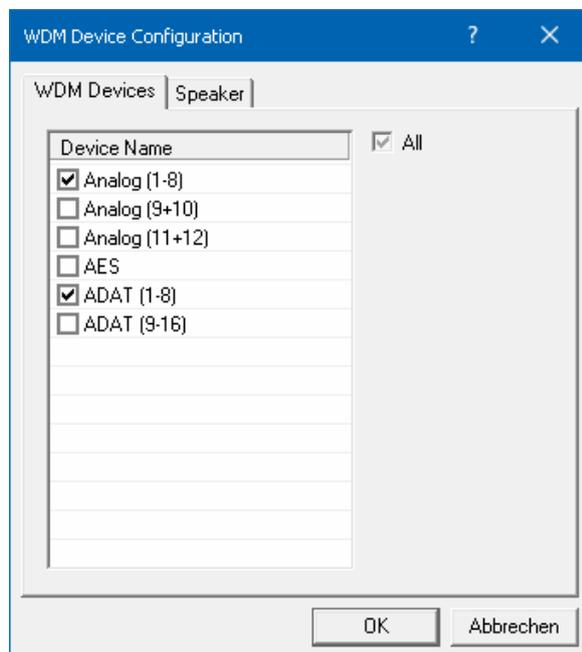
Der Screenshot links zeigt die Multichannel WDM Devices des UFX II nach Auswahl der Option 'Multi-Channel' im Feld WDM Devices und Klick auf den Knopf *WDM Configure*. In diesem Beispiel sind die Devices *Analog 1 bis 8* und *ADAT 1 bis 8* aktiviert.
