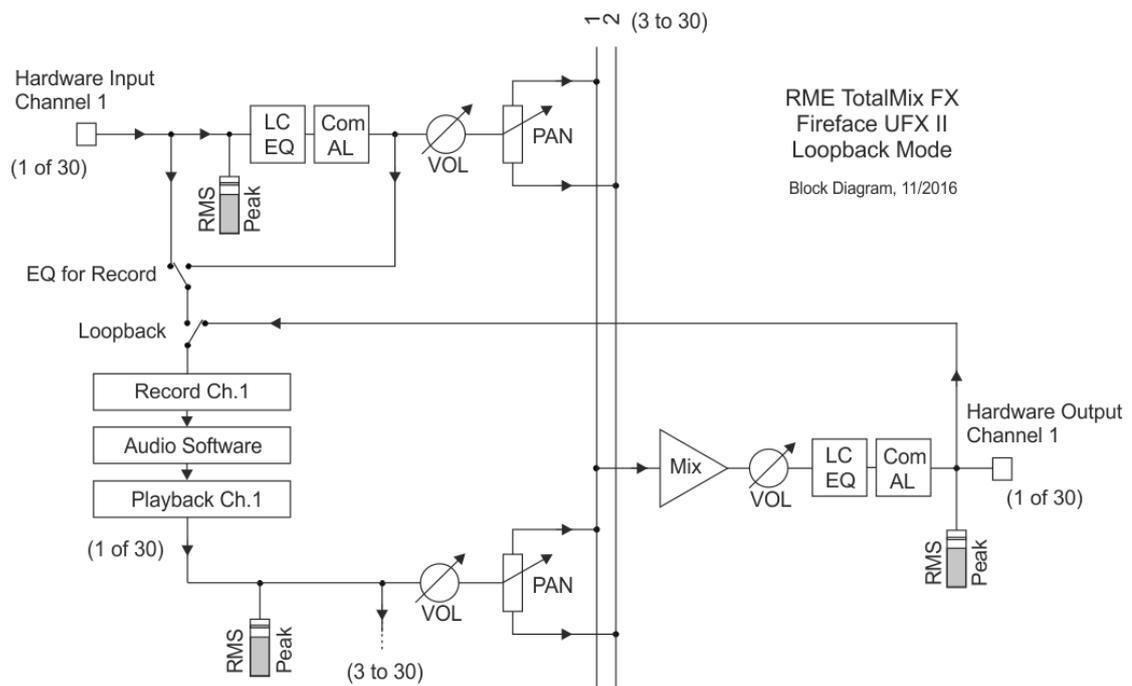
Das Blockschaltbild zeigt auch, warum sich bei aktiviertem Loopback der EQ des Hardwareausgangs im Aufnahmeweg befindet. Mit Loopback aktiv ist der EQ des Eingangs selbst bei aktivierter Option *DSP – EQ+D for Record* nicht im Aufnahmeweg, sondern nur im Monitoring.
