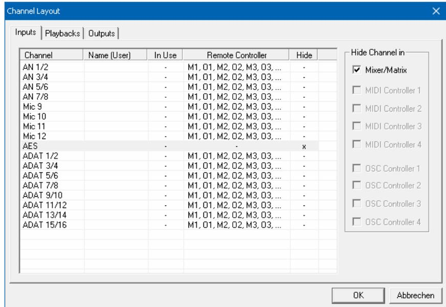
Im obigen Beispiel wurde der AES Input unsichtbar gemacht. Ist AES nicht in Benutzung kann man ihn so sehr einfach ganz aus TotalMix entfernen. Komplexere Setups zeigen z.B. ausschließlich die Kanäle der Drum-Sektion, der Bläser, oder der Streicher.
