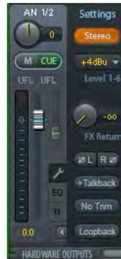
**Loopback.** Sendet die Ausgangsdaten an den Treiber als Aufnahmedaten. Der entsprechende Submix kann dadurch aufgenommen werden. Der Hardwareeingang dieses Kanals sendet seine Daten nur noch an TotalMix, nicht mehr zur Aufnahmesoftware.
