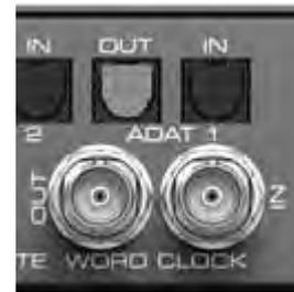
Nach Anwahl der Option *Single Speed* im Settingsdialog wird die Ausgangsfrequenz angepasst, so dass sie immer im Bereich 32 bis 48 kHz ist. Bei 96 kHz und 192 kHz Samplefrequenz wird also 48 kHz ausgegeben.
