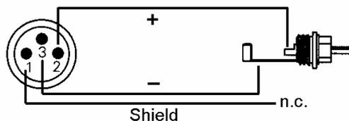
Der optische und der XLR-Ausgang arbeiten im AES-Betrieb parallel, geben also ein identisches Signal aus. So lassen sich auch zwei SPDIF-Geräte gleichzeitig anschließen, und das Fireface als Splitter benutzen (Verteilung 1 auf 2).
