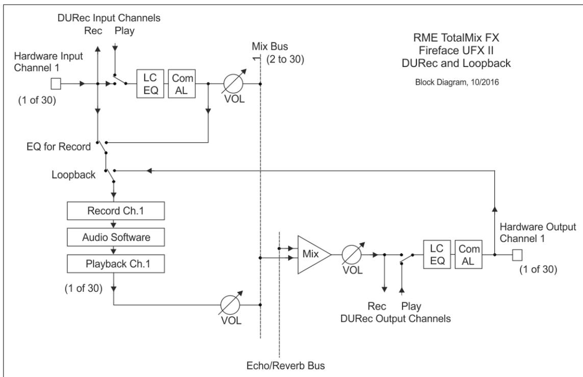
Das Blockschaltbild zeigt den Signalfluss für verschiedene Situationen, abhängig von den Schalterstellungen *Loopback*, *EQ for Record* und *Play aktiv*. *Loopback* und *EQ for Record* sind im Diagramm nicht aktiv, im Eingang erfolgt jedoch gerade eine Wiedergabe.
