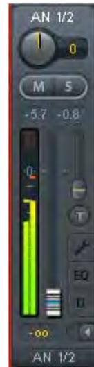
**Levelmeter.** Das Meter zeigt sowohl Peak (Zero Attack, 1 Sample reicht zur Anzeige der Vollaussteuerung) in Form eines Striches, als auch mathematisch korrekten RMS als Balken. Die Anzeige RMS ist mit einer relativ langsamen Zeitkonstante versehen, so dass sie recht gut die durchschnittliche Lautstärke darstellt. Over erscheinen rot am oberen Ende des Meters. Über F2 (Preferences) ist sowohl die Peak Hold Time, die Over-Erkennung als auch der RMS-Bezugswert einstellbar.
